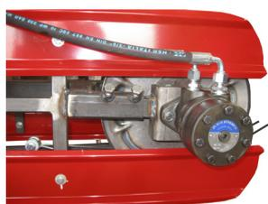
Abb. 3 Anbau mit Hydraulikmotor
