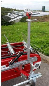
Abb. 2 Detail Gerüstgruppe mit Rad und Hebel zur Einstellung der Höhe
