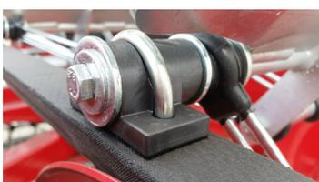
Abb.2 Detail der Halterung und der Buchsen aus selbstschmierendem Material
