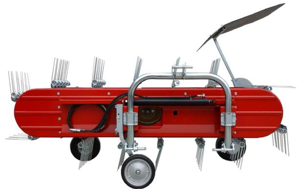
Abb. 7 Dreieck-Anschluss mit Stange und Tastrad
