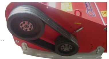
Abb.2 Detail Antrieb
