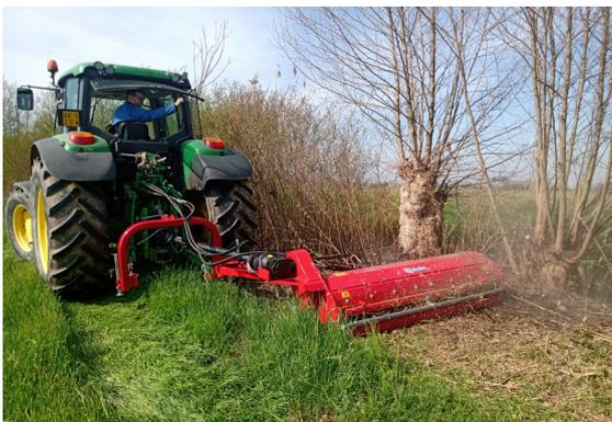
Abb.1 Seitenmulcher TRL E in ausgefahrener Position
