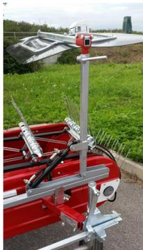
Abb. 3 Hydraulischer Heuschutz einzelne Bewegung
