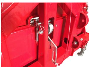
Abb. 3 Detail Freigabesystem MEC MINI/MIDI mit Sicherheitsstift
