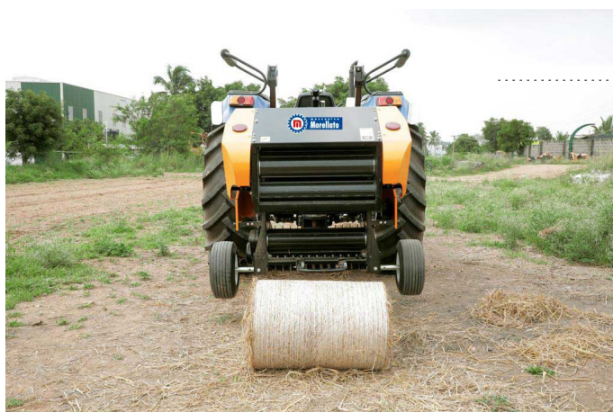
Abb. 2 Ballenpresse SBA 330N mit Umwicklung mit Juteschnur
