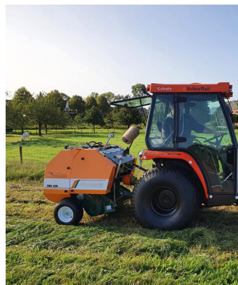
Abb. 1 Ballenpresse SBA 330N mit Umwicklung mit Nylonnetz
