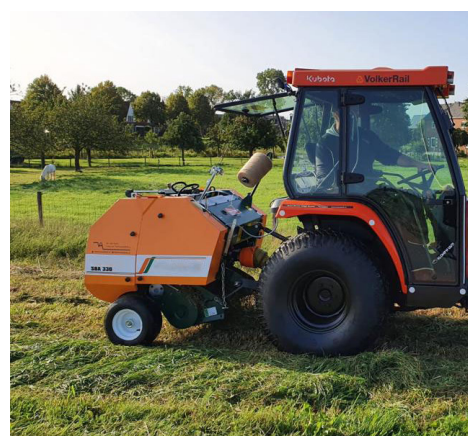
Fig. 1 Imballatrice SBA 330N con avvolgimento a rete di nylon Baler SBA 330 N with nylon net
