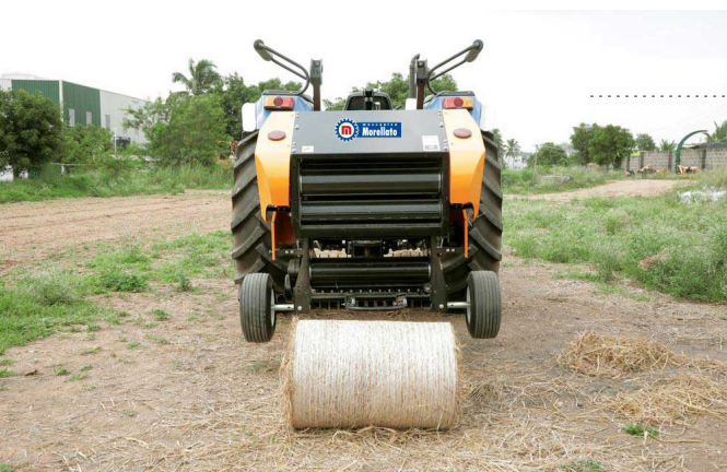
Fig. 2 Imballatrice SBA 330N con avvolgimento a spago in juta Baler SBA 330N with jute twine wrapping
